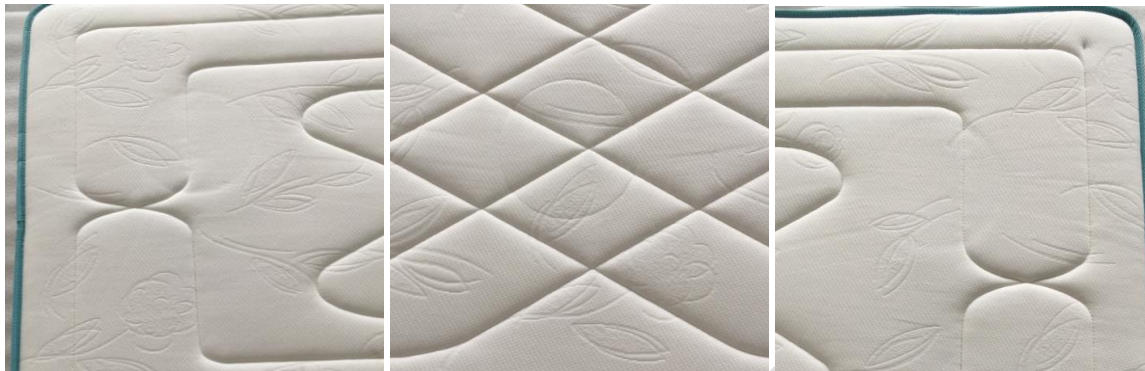
Obr. č. 7 – Vzorek č. 462204085/01 – detail otlaků zkušebního tělesa po provedení 10.000 cyklů
